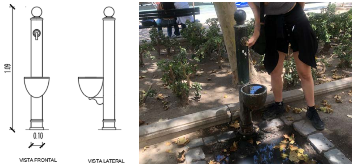
Figura 11. (izquierda) Planimetría y (derecha) fotografía del bebedero fierro forjado. Funete: Subdirección de Ornato, Parques y Jardines; y Archivo ONG Poloc 2022, respectivamente.
